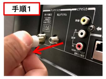
ご家庭のテレビ裏面の、「地上デジタル」と書いて ある端子側に差し込んで いる同軸ケーブルの線を 抜きます。
