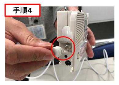
二股に分かれた線の 白い方のケーブルを ラジオ左側面の端子 に取り付けます。 これでケーブルテレビ の線との接続は完了 です。
