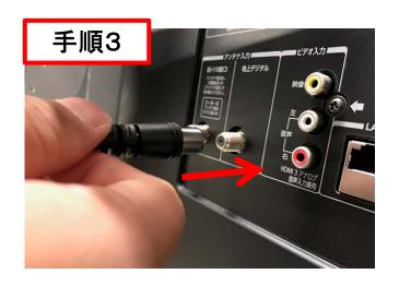
接続セットの黒い同軸 ケーブルを「手順1」で 抜いた、テレビの「地上 デジタル」と書いた端子 に差し込みます。
