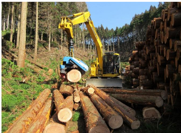
高性能林業機械による造材・集材作業
