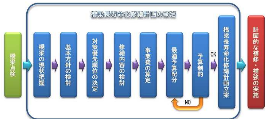
図5 橋梁維持管理のメンテナンスサイクルの概念
