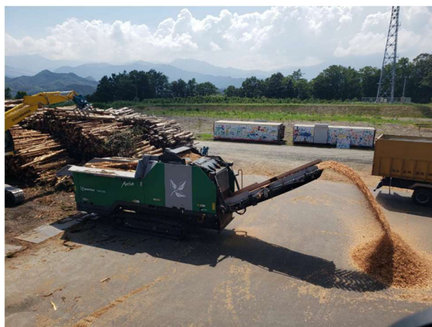
移動式破砕機（チップパー）
