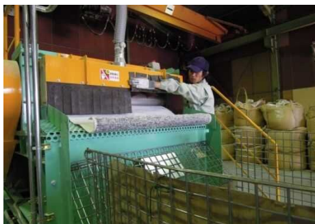
図表 31 破碎機での破碎の様子
